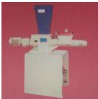
modèle DELTA VDiam de boudin 60mmProduction : 120Kg/hPuissance moteur : 0,75 kW Poids : 190Kg Dimension : L 1340/l 525/H 1665 Matériel en parfait état
