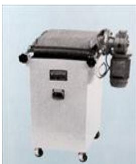
A tapis en caoutchouc mousse spécial abrasif-Auget pour rinçage en continue et essorage par un rouleau essoreur-Surface utile de travail 350/300mm-Vernis spécial anticorrosif-Puissance moteur 0,25KW-Encombrement 650/700/790mm-Poids 95KgMatériel en parfait état de marche.os
