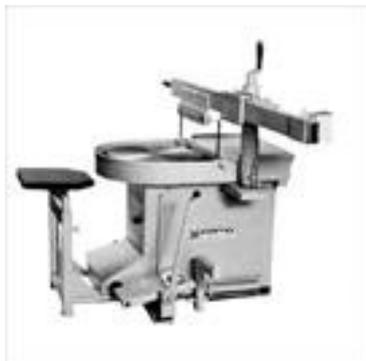
Variation électronique de vitesse commandée par pédale et par levier manuel, stabilisation de vitesse possible. Ce tour est prévu pour recevoir un bras de calibrage ainsi que des supports de moules (en option).
